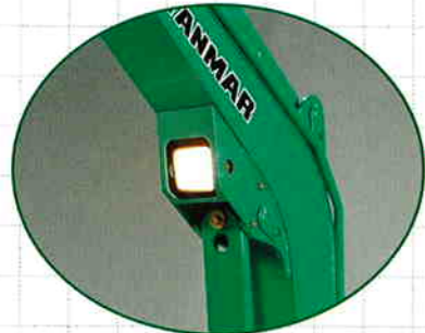
作業用ライトを破損の少ない ブーム下部にすっきり内装
