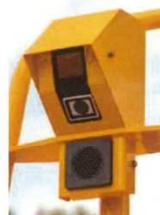
3Dセンサ 後方カメラ 後方用スピーカー
